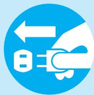
電気器具はできるだけ直接コンセントから使用し、差し込みプラグはキッヂリ奥まで差し込んでください。キッヂリ差し込まれていないと接触不良による過熱事故の原因となります。
